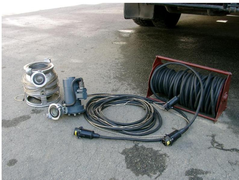
Рисунок 2.2 – Узлы СЭМПА-001
