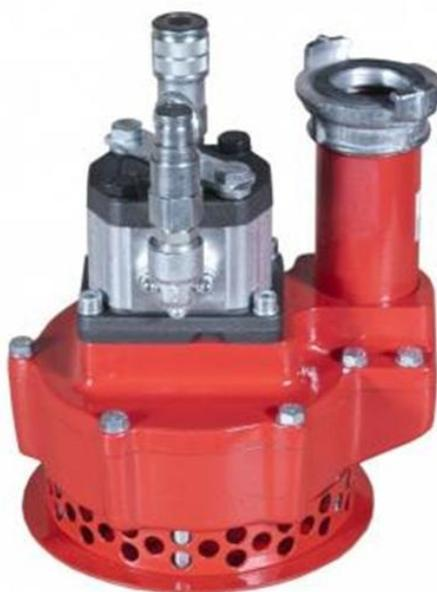
Рисунок 8.1. – Погружной насос, состоящий из насосной части нормального давления (внизу) с всасывающей сеткой и выводом через рукавную пожарную головку и турбинной части высокого давления со штуцерами подвода и отвода масла для соединения рукавами высокого давления с высоконапорным насосом гидропривода
